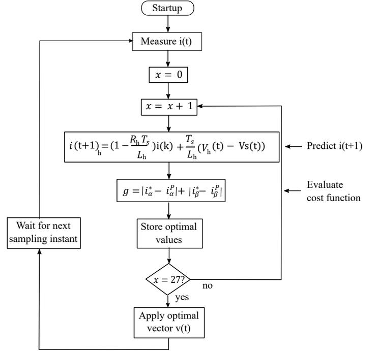
Fig. 6. Control Diagram.
